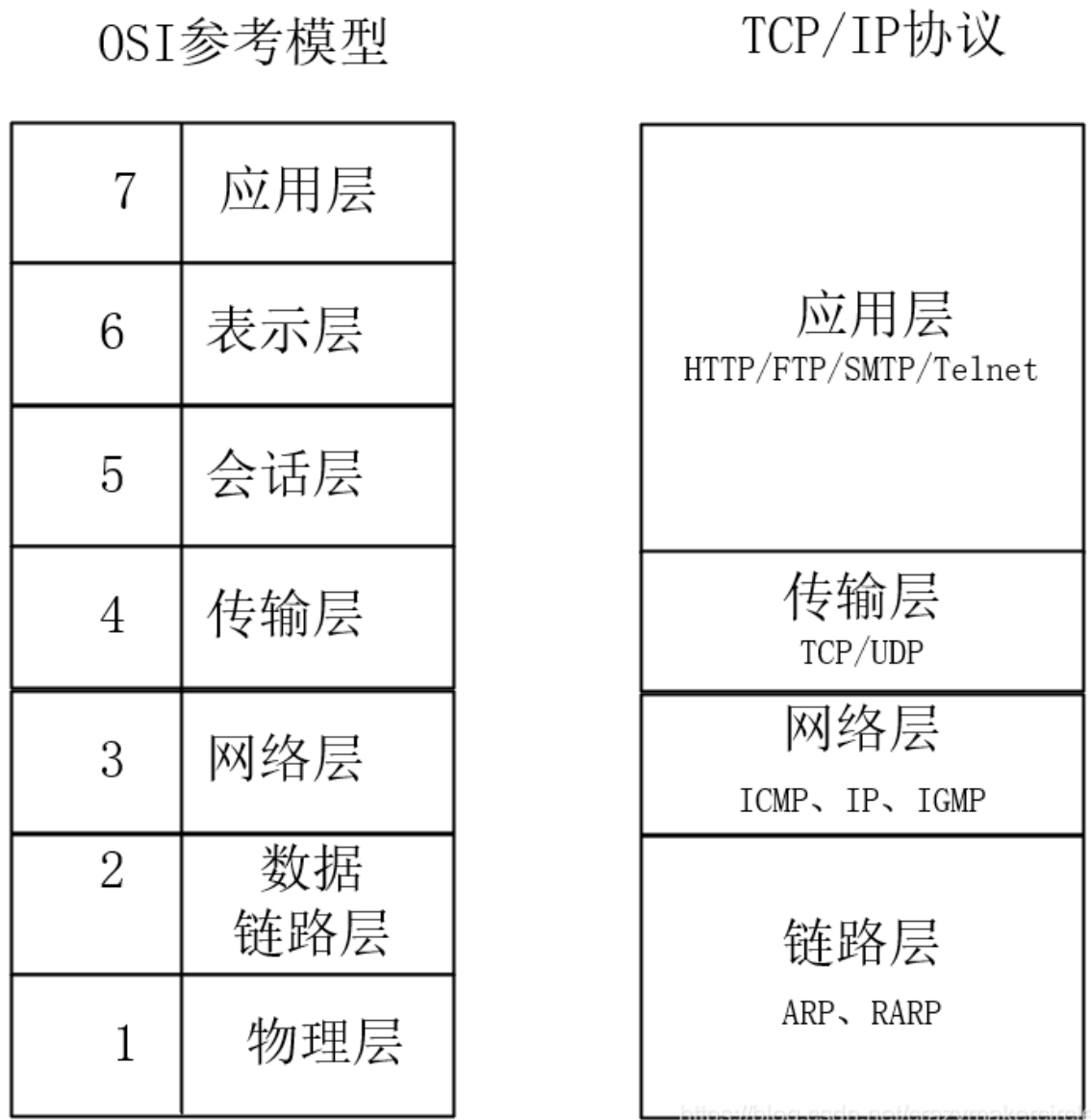
图：TCP/IP协议与七层ISO模型的对应关系
